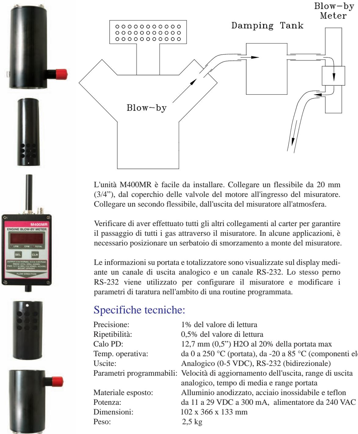
L'unità M400MR è facile da installare. Collegare un flessibile da 20 mm (3/4"), dal coperchio delle valvole del motore all'ingresso del misuratore. Collegare un secondo flessibile, dall'uscita del misuratore all'atmosfera.
